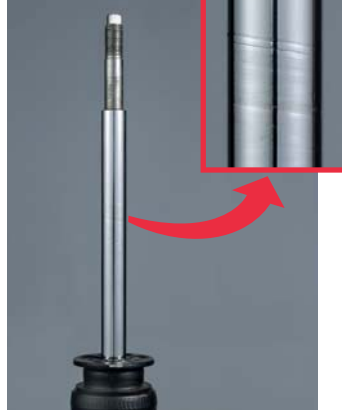
Повреждена поверхность штока
